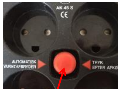
Sikringsknap som afbryder strømmen, hvis ledningen bliver for varm. (Det er samme princip i en gulvmaskine).
