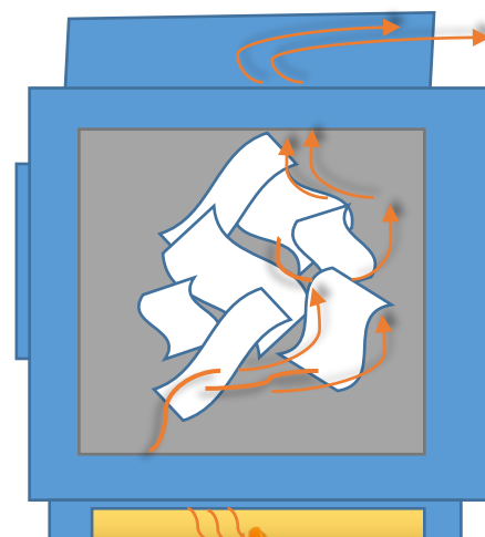
Luftens og tøjets bevægelser i tørretumbleren. Ill. Joan Serritzlev
