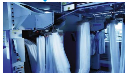
Tunnelfinish af beklædning
