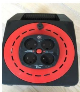
Forlængerledning på tromle.
