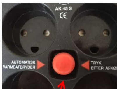
Sikringsknap som afbryder strømmen, hvis ledningen bliver for varm. (Det er samme princip i en gulvmaskine).
