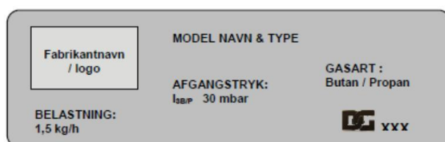
Figur 4-6. Eksempel – Mærkeskilt på regulator.
