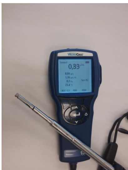
Varmetrådsanemometer med en føler, der er velegnet til måling i kanaler.
