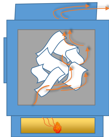
Luftens og tøjets bevægelser i tørretumbleren. Foto: Joan Serritzlev
