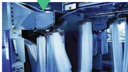
TUNNELFINISH AF BEKLÆDNING
