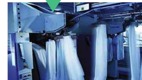
TUNNELFINISH AF BEKLÆDNING
