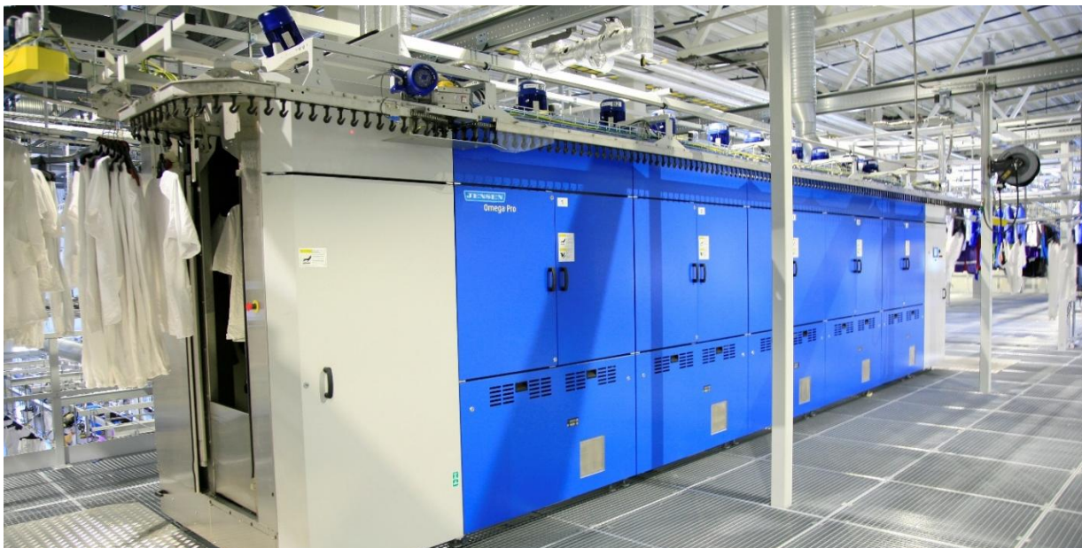
Beklædning på bøjler på vej igennem tørretunnelen Omega tunnel Finisher MG3557
